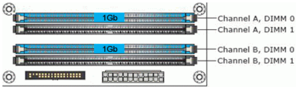
Рис. 48. Установка двух модулей памяти в двухканальном режиме
