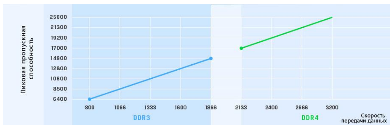
Рис. 9. Скорость передачи данных DDR4
