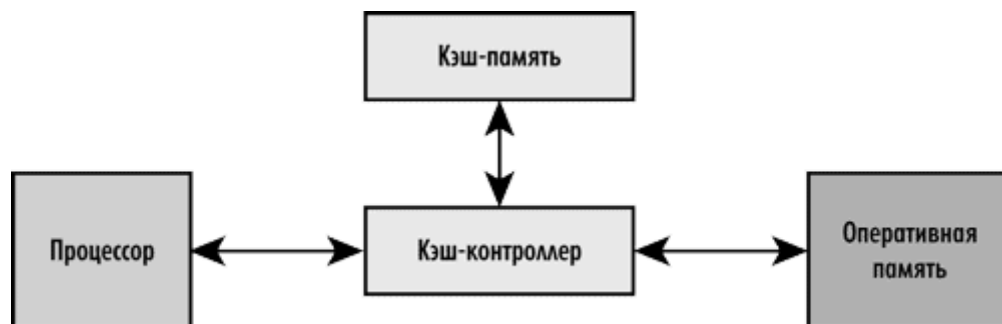
Рис. 5. Структура кэш-памяти процессора
