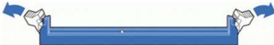
Рис. 42. Подготовка слота к установке модуля памяти
