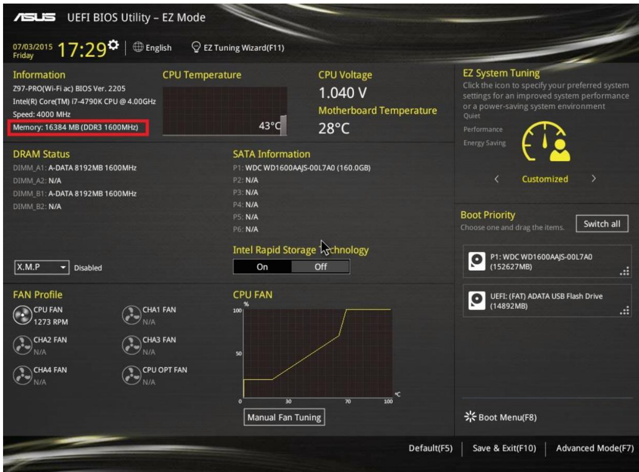
Рис. 56. Определение действующей частоты модулей памяти
