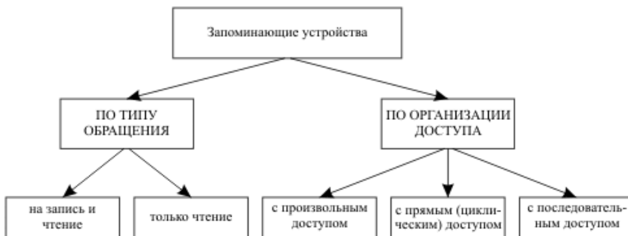
Рис. 2. Классификация запоминающих устройств
