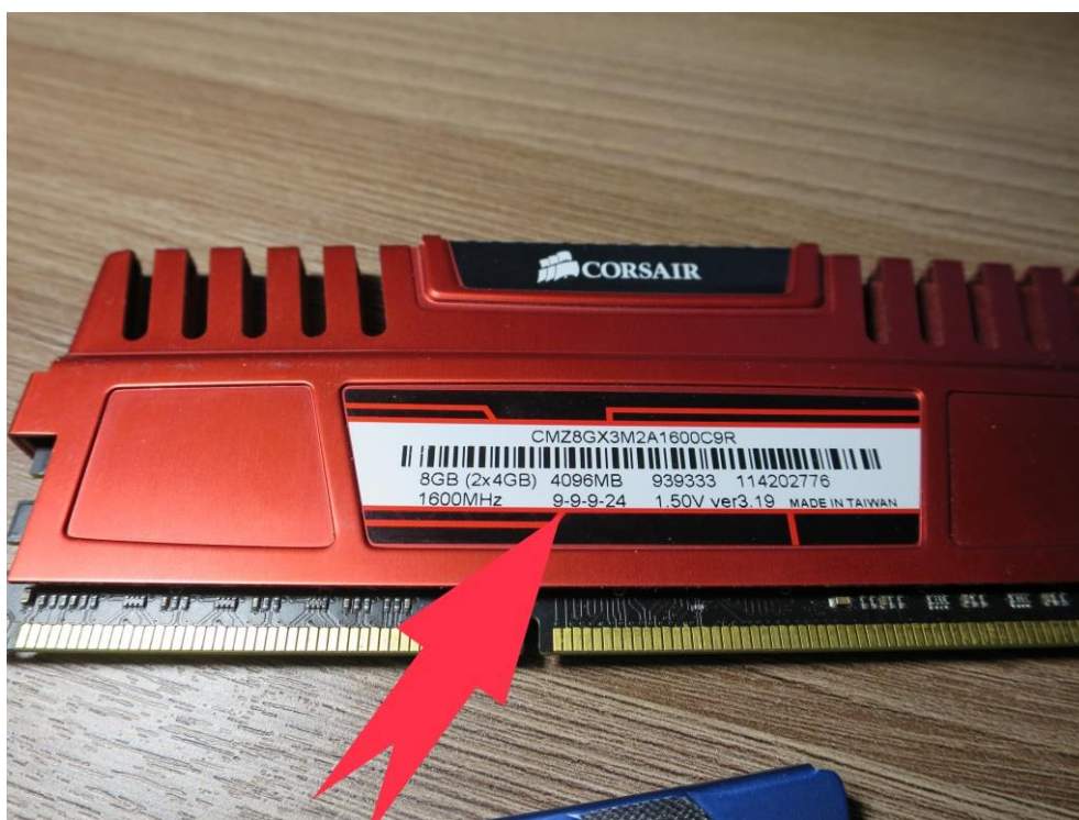
Рис. 14. Полное обозначение таймингов
