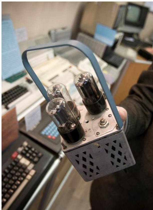
Рис. 26. Запоминающая ячейка БЭСМ на 1 бит
