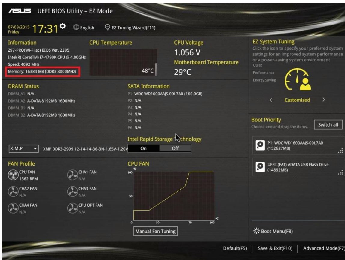
Рис. 60. Проверка применения XMP профиля 1
