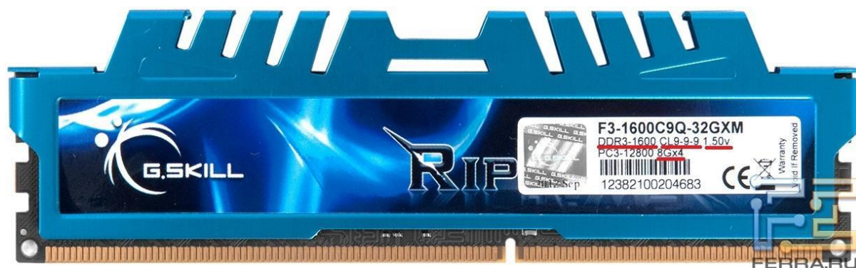
Рис. 40. Модуль G.SKILL типа DDR3
