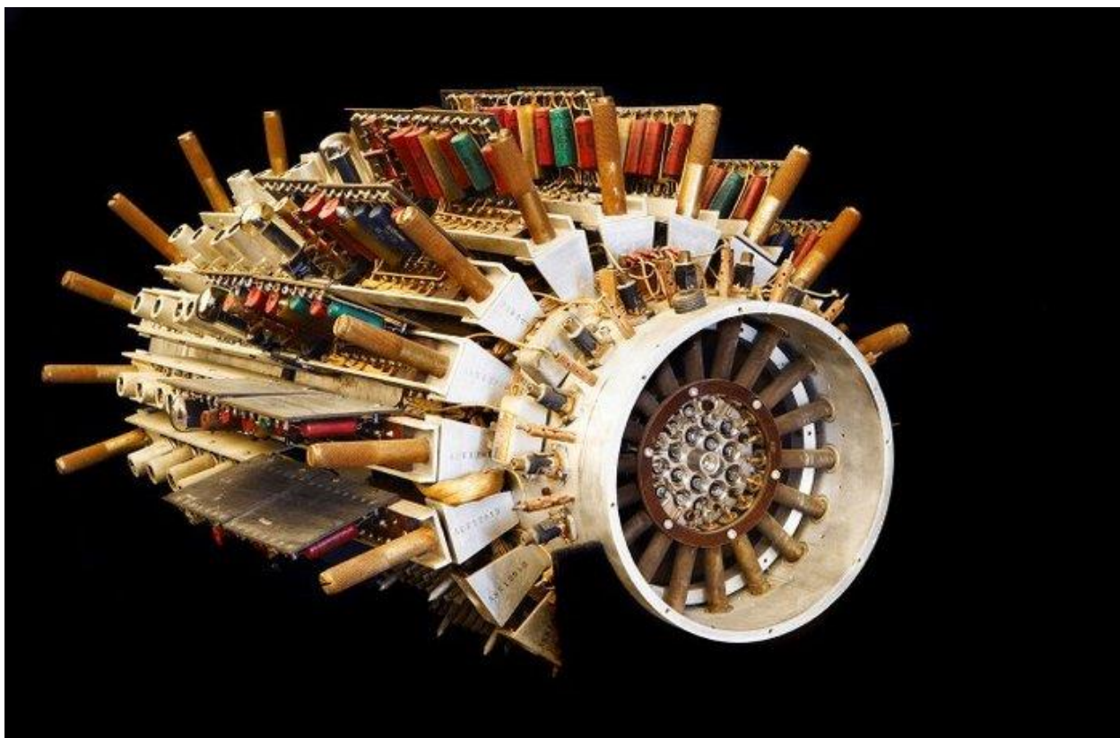
Рис. 29. Массив памяти на ртутных линиях задержки
